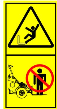
Baje siempre el cazo hasta el suelo antes de abandonar el asiento del operario. La minicargadora no está diseñada para mantener la carga levantada durante mucho tiempo.
